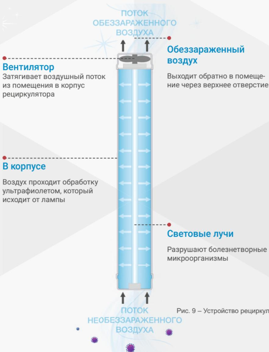
Рис. 9 – Устройство рециркулятора
