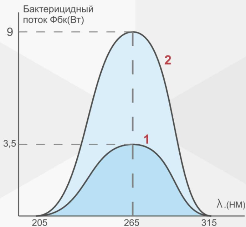
Рис. 10 – Спектральное распределение плотности потока излучения:
