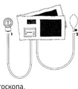
**ПРИМЕЧАНИЕ:** расположение стрелки манометра не по центру нулевой области, обозначенной символом «□» не является браком прибора. Стрелка манометра должна находиться в пределах нулевой области, которая устанавливается изготовителем при юстировке прибора в необходимом положении для обеспечения требуемой точности.
